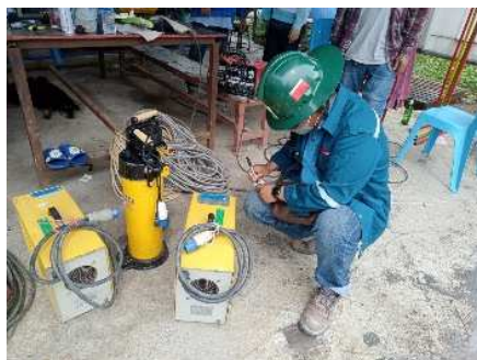
รูปที่ ค-48 ตรวจสอบสภาพเครื่องเชื่อมท่อก๊าซให้อยู่ในสภาพพร้อมใช้งาน
