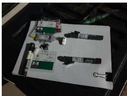
รูปที่ ค-55 ตรวจสอบและติด Film Badge หรือแผ่นวัดรังสีก่อนเริ่มงานตรวจสอบรอยเชื่อมด้วยรังสี
